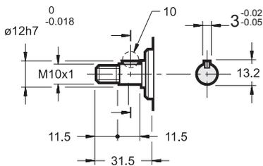
цилиндрический вал со шпонкой
