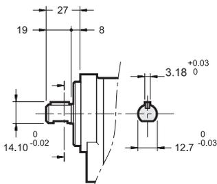
Цилиндрический вал со шпонкой по SAE J744
