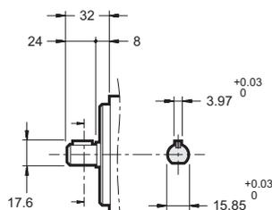
Цилиндрический вал со шпонкой по SAE J744
