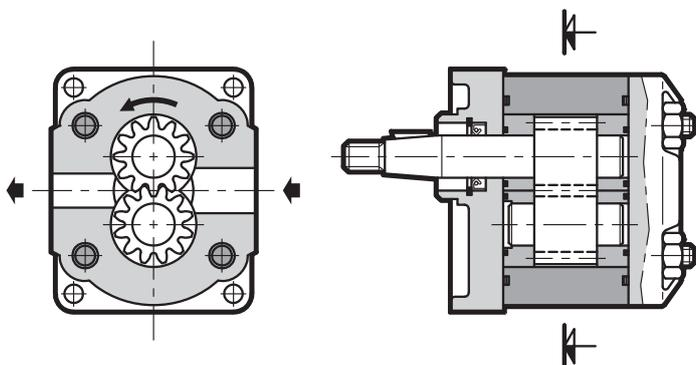
— Насосы GP представляют собой насосы фиксированной производительности с шестернями внешнего зацепления с компенсацией осевого зазора.
