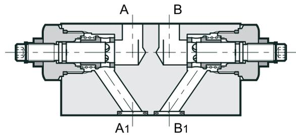
—Этот клапан является дросселем со встроенным обратным клапаном для свободного обратного потока, изготовленным в модульном исполнении с монтажной поверхностью, соответствующей стандартам СЕТОР и ISO.
