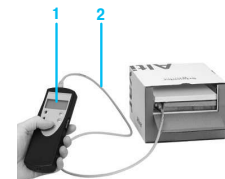
Конфигурирование ПЧ в упаковке с помощью мультизагрузчика WV3 A8 121+ кабель WV3 A8 126
