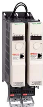
ATV 32H●●●M2 Два преобразователя частоты, последовательно (daisy chain) соединенные по звену постоянного тока при помощи кабеля
