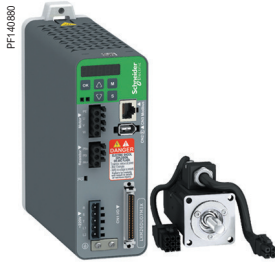
Комплект сервопривода Lexium Easy 26 LXM26V●●MB3● включает в себя: - 1 сервопреобразователь Lexium Easy 26 (50...100 Вт) - 1 серводвигатель BCH2, фланец 40 мм
