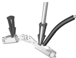
Принцип работы технологии с прорезанием изоляции
