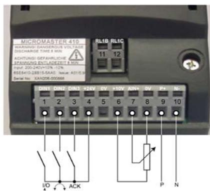
Рисунок 3-3 Базовое подключение
