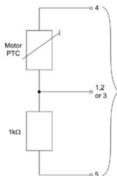
При работе привода с частотой вращения ниже номинальной, эффективность охлаждения с помощью вентилятора, установленного на валу двигателя снижается. Следовательно, большинство двигателей требует уменьшения нагрузки для непрерывной работы на низких частотах. Чтобы гарантировать защиту двигателя от перегрева при этих условиях, РТС температурный датчик, должен быть установлен на двигателе и подключен к клеммам управления инвертора, а параметр P0601 должен быть активизирован.
