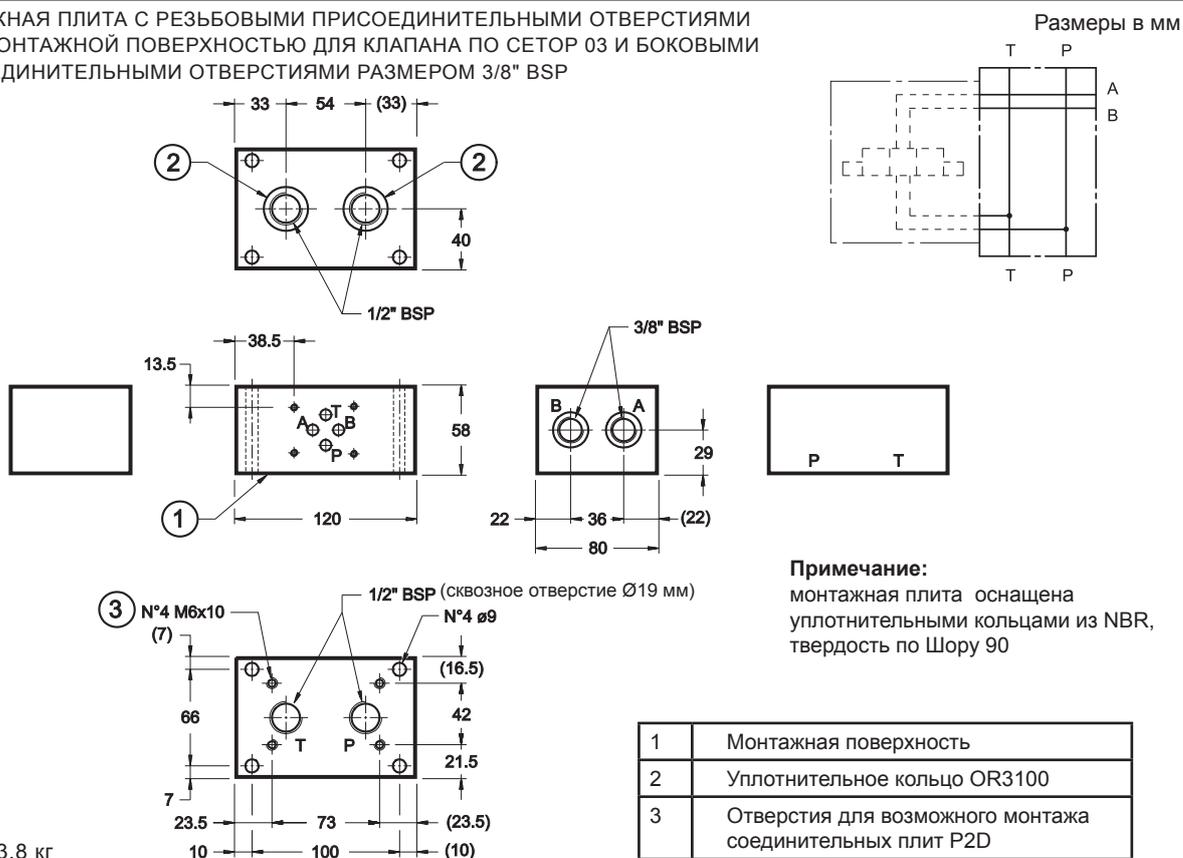
**5 - ГАБАРИТНЫЕ И МОНТАЖНЫЕ РАЗМЕРЫ модели P4D-D3P/21 (код 1561481)**
