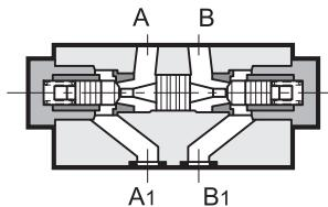
—Этот клапан является обратным клапаном с гидравлическим управлением, закрывающей пружиной и конусом на краевых уплотнениях, монтажная поверхность соответствует стандартам СЕТОР и ISO.
