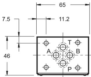
1 Монтажная поверхность с уплотнительными кольцами:
