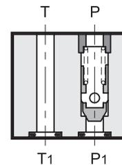
—Клапан MVR является обратным клапаном в модульном исполнении с монтажной поверхностью, соответствующей стандартам СЕТОР и ISO.
