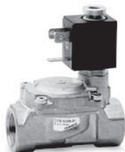
Направляющая часть соленоидного клапана непрямого действия регулирует положение мембраны посредством дифференциального давления. Поэтому клапан, в частности, пригоден для регулирования высокой скорости расхода и работает с очень низким рабочим давлением.
